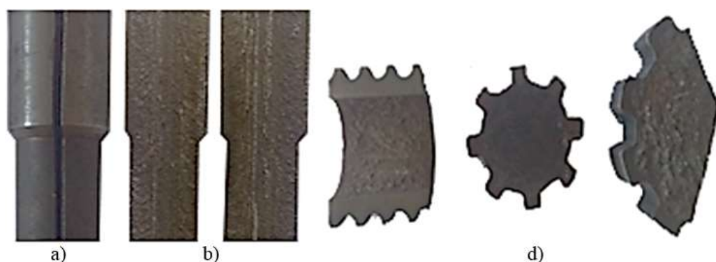
1.2-rasm. Makronamuna tayyorlash uchun tekshirilayotgan namunalar: a - detal; b - detalning kesilgan bo'laklari; d - makronamunalarning boshqa uch xil tuzilishlari.
