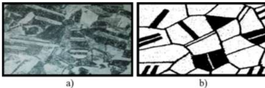
7.2-rasm. Bosim ostida ishlov berilgan deformatsiyalangan va yumshatilgan \alpha - latun strukturasi (a) X100 va sxemasi (b).
