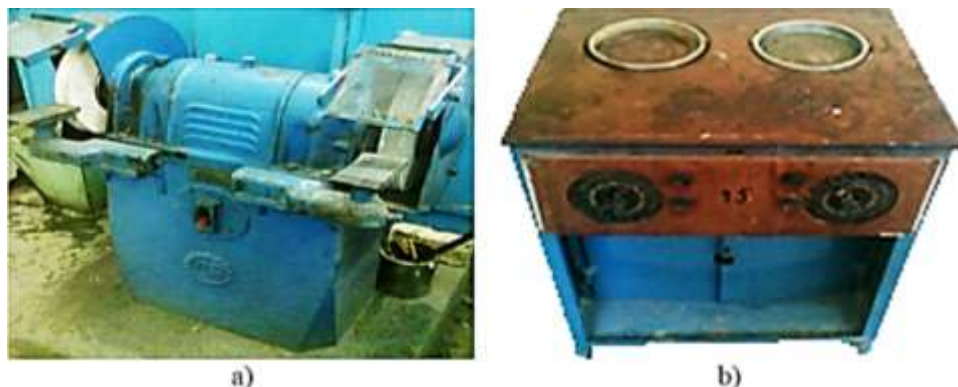
1.5-rasm. Jilvirlash stanokining yirik (qora tosh) va mayda (oq tosh) donador toshlari bilan (a) va silliqlash stanokining tepa stolidagi birinchi dumaloq namunalarni jilvirlash qismi va ikkinchi dumaloq namunalarni mayin silliqlash qismi (b) umumiy ko'rinishlari.
