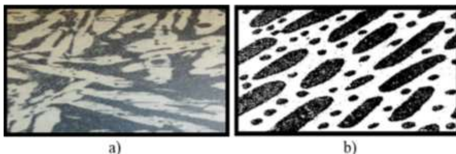
7.4-rasm. Qalayli quyma bronzaning mikrostrukturasi (a) X200 va sxemasi (b): strukturadagi va sxemadagi uzunchoq qoramtir dog'lari ( \alpha ) va kichikroq qora nuqtalari esa ( \delta ) tuzilishlari.
