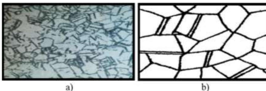
7.1-rasm. Bosim ostida ishlov berilgan quyma va yumshatilgan misning mikrostrukturasi (a) X200 va sxemasi (b).
