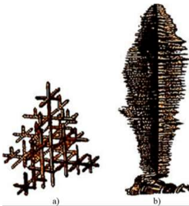
1.4-rasm. Metall quymalardan hosil bo‘lgan dendrit (a) va kristall shakli (b) tuzilishlari.
