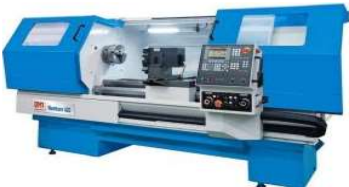
15.3-rasm. 1K62 modeli universal tokarlik vint-kesar dastgohining yangi zamonaviy raqamli dasturda boshqariladigan (RDB) ko'rinishi.
