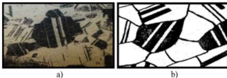
7.5-rasm. Bosim ostida ishlov berilgan va yumshatilgan bronzaning mikrostrukturasi (a) X250 va sxemasi (b).
