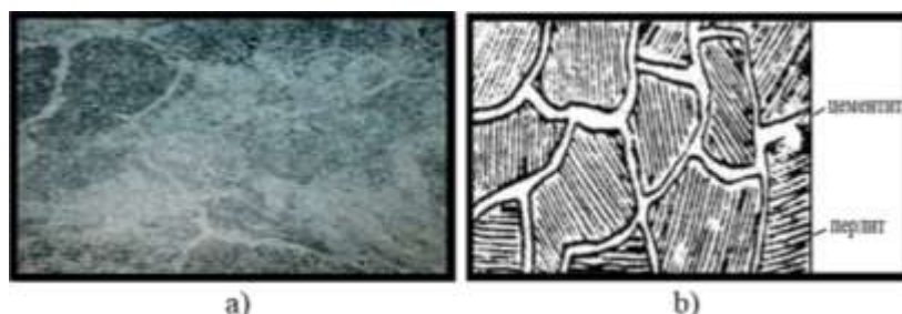
4.5-rasm. Evtektoiddan keyingi po'latning mikrostrukturasi (a) X500 va sxemasi (b) ko'rinishlari.
